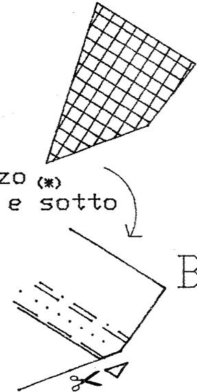
A Lavorando con calma, usate un saldatore a punta, sul 30 Watt, per imbastire un punto ogni 3 centimetri per fondere gli strati di dacron e spi insieme
